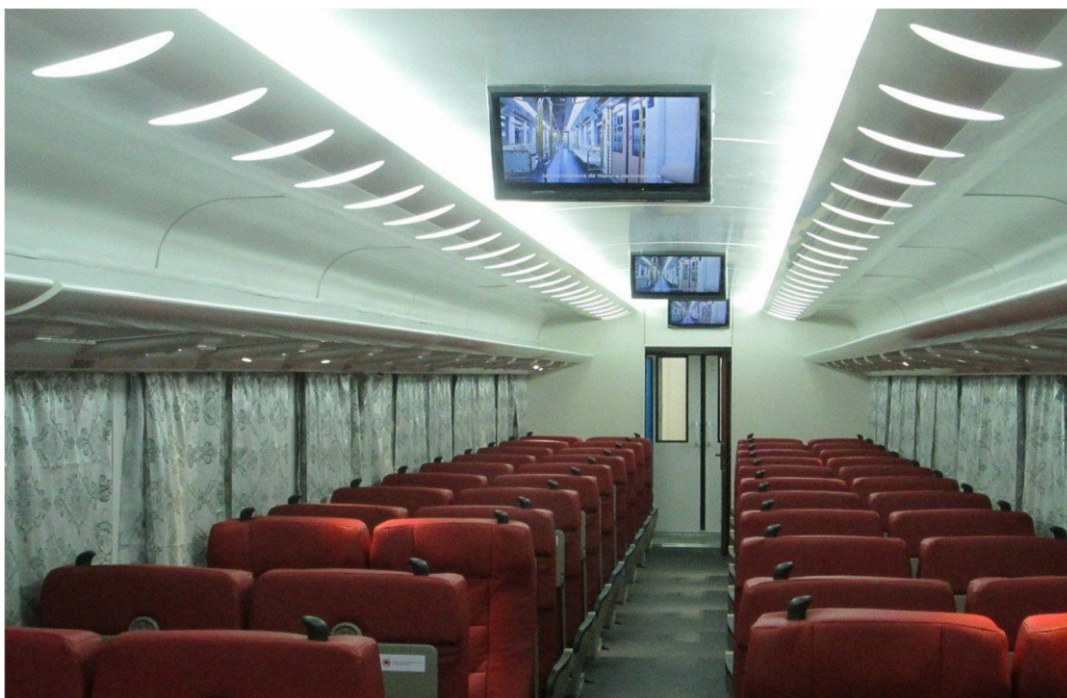
Coche tipo 1: sistema de televisión y video, sistema de climatización, capacidad: 72 asientos reclinables y giratorios, dos baños, bebedero de agua fría. Foto: Juventud Técnica.
