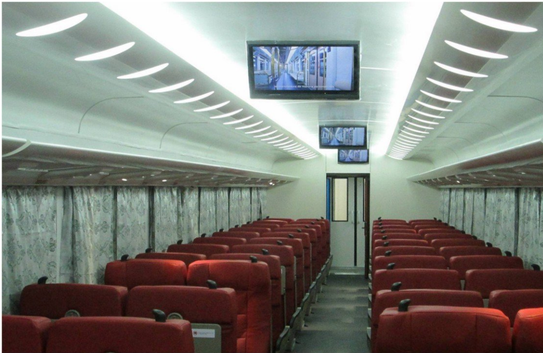
Coche tipo 1: sistema de televisión y video, sistema de climatización, capacidad: 72 asientos reclinables y giratorios, dos baños, bebedero de agua fría. Foto: Juventud Técnica.
