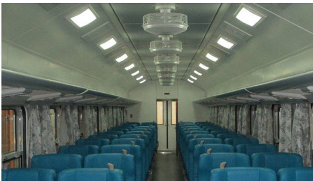
Coche tipo 2: sistema de audio, 12 ventiladores de techo, 72 asientos reclinables y giratorios, dos baños, bebedero de agua fría. Foto: Juventud Técnica.
