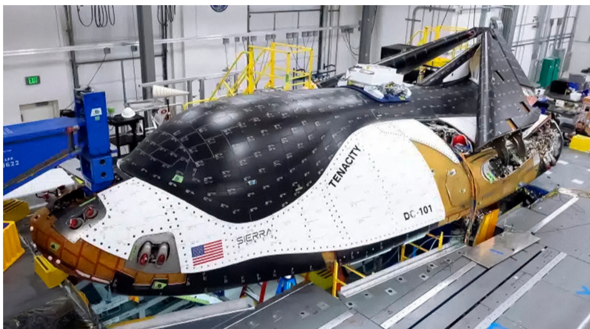
Tenacity, el primer modelo de nave espacial de la flota Dream Chaser, que será utilizado para transportar carga hacia la Estación Espacial Internacional. Foto: Sierra Space. Tomada de RT.
